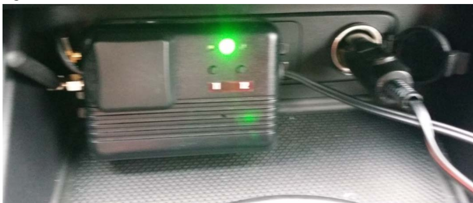
Pokud přejde jednotka do stavu jízdy (změna GPS a akcelometru) je toto opticky signalizováno rozsvícením zelené LED:
